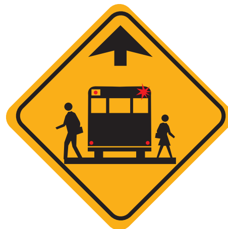
Panneau avancé Arrêt d'autobus scolaire caché
